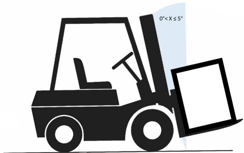
Obr. 9: Klopný úhel při přepravě vysokozdvížným vidlicovým vozíkem
